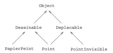
En particulier : l'arbre des objets n'est plus un arbre puisque Point a deux antécédents distincs. En pratique cela ne pose aucun problème car les interfaces ne programmant aucune méthode il n'y aura jamais d'ambiguité (même si par hazard la même signature de méthode était définie dans les interfaces Deplacable et Dessinable). En pratique un objet de type Point peut être considéré soit comme un objet Deplacable soit comme un objet Dessinable : les lignes suivantes sont correctes :
