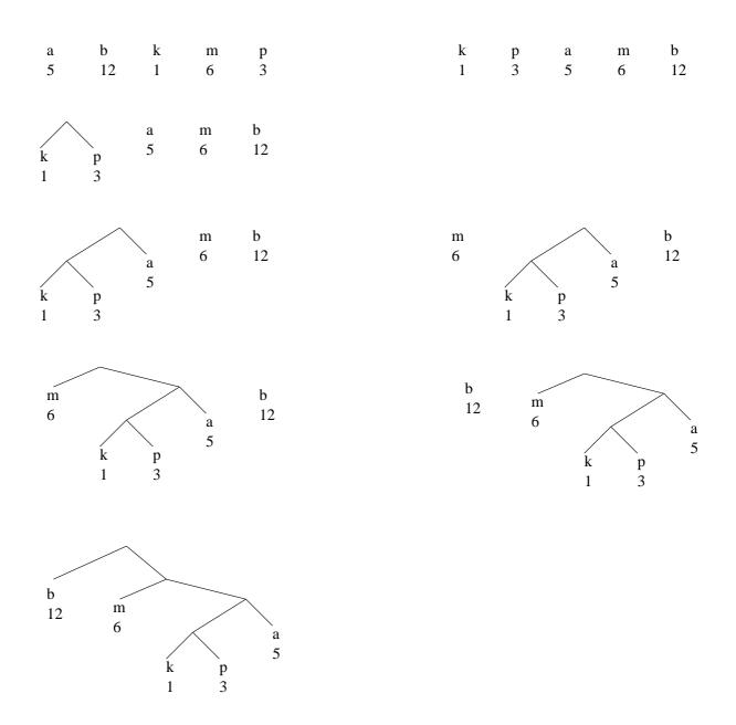
Fig. 2 – Construction d'un arbre de Huffman
