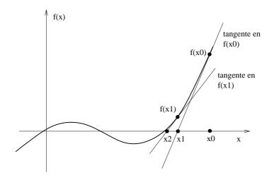
Fig. 1 – Algorithme de Newton
