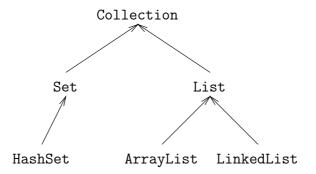
Fig. 1 – L'interface Collection, ses sous-interfaces et leurs implantations
